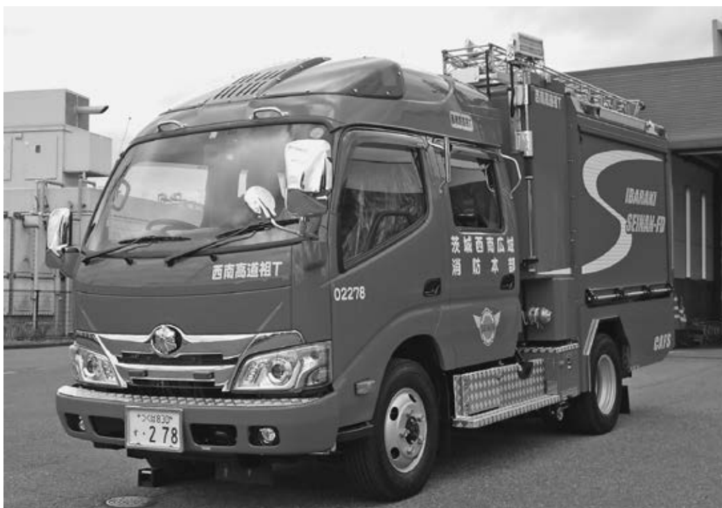
消防ポンプ自動車 (CD - I 型・1,300L 水槽・CAFS 装置搭載) 令和2年度 高道祖出張所消防ポンプ自動車更新
